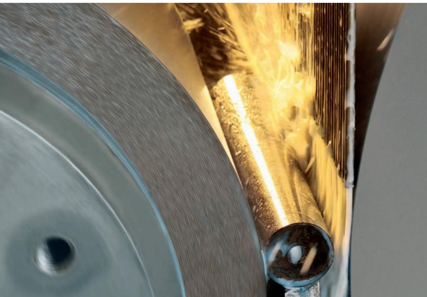
Die spitzenlosen Schleifmaschinen der Baureihe JUPITER bringen erhebliche Produktionsvorteile mit sich: Die patentierte CNC-Höhenverstellung der Auflageschiene minimiert die Rüstzeit, die automatische Einstellung der Schleifspaltgeometrie optimiert den Schleifprozess und das Schrägbett garantiert höchste Formgenauigkeit. Je nach Anwendung kommt als Schleifmittel Korund, CBN oder Diamant zum Einsatz.
