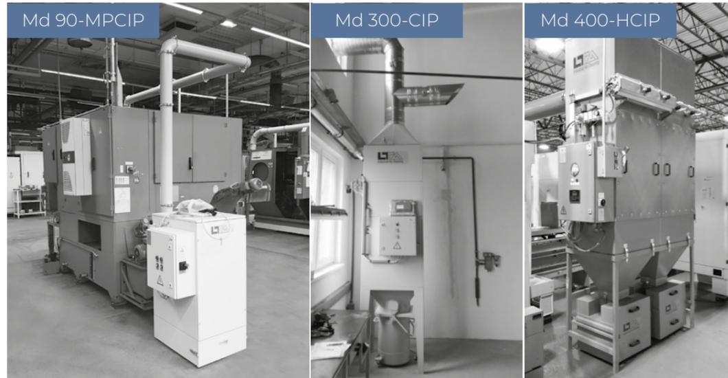
Os filtros mecânicos de substâncias sólidas para poeiras da LTA Lufttechnik servem utilizados para a captação e separação de poeiras e fumos de qualquer tipo. Os sistemas de filtragem são utilizados em aplicações industriais simples, mas também em situações de complexas exigências industriais e filtragens com especificações específicas do cliente. Estão disponíveis filtros de cartucho e de saco para purificar partículas nocivas para a saúde.
